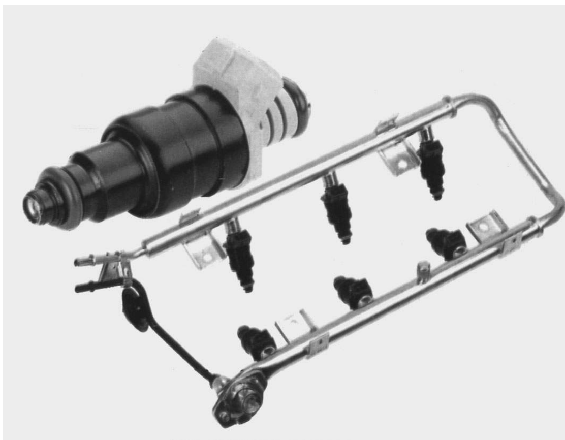
รูปที่ ๖ ระบบหัวฉีดและท่อทางส่งน้ำมันเชื้อเพลิง
