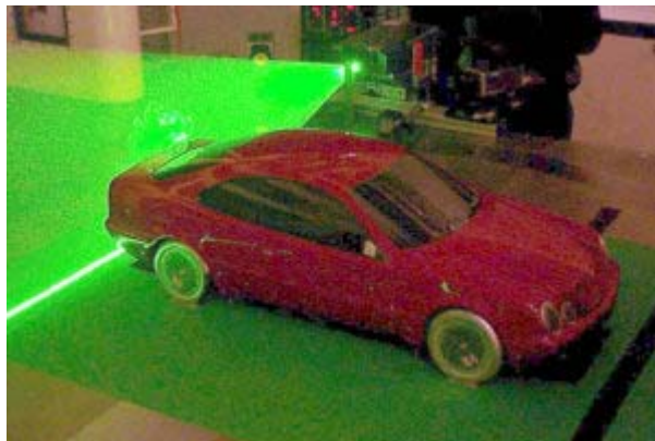
รูปที่ ๑ การศึกษาการไหลของอากาศบริเวณส่วนท้ายของรถยนต์
