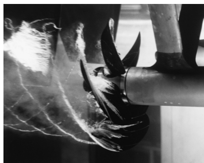
ภาพการเกิด Cavitation จากใบจักร
